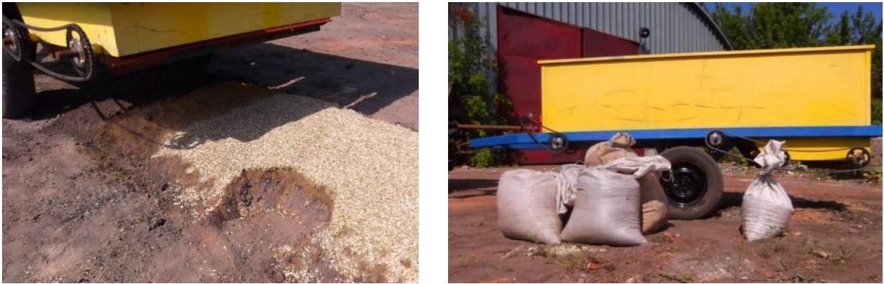
Рисунок 4 – Общий вид комбинированного укладчика и процесс укладки почвенных компонентов.
